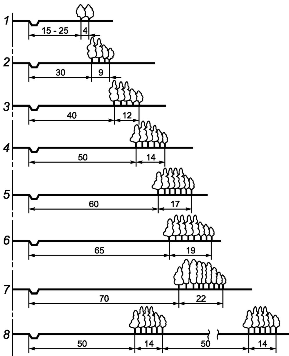
Объемы снегоприноса: 1 — 25 м<sup>3</sup>/м; 2 — 50 м<sup>3</sup>/м; 3 — 75 м<sup>3</sup>/м; 4 — 100 м<sup>3</sup>/м; 5 — 125 м<sup>3</sup>/м; 6 — 150 м<sup>3</sup>/м; 7 — 200 м<sup>3</sup>/м; 8 — 250 м<sup>3</sup>/м
